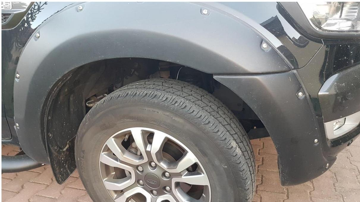
Radhausverbreiterung Typ Fibertek Fender Flare Vorderachse
