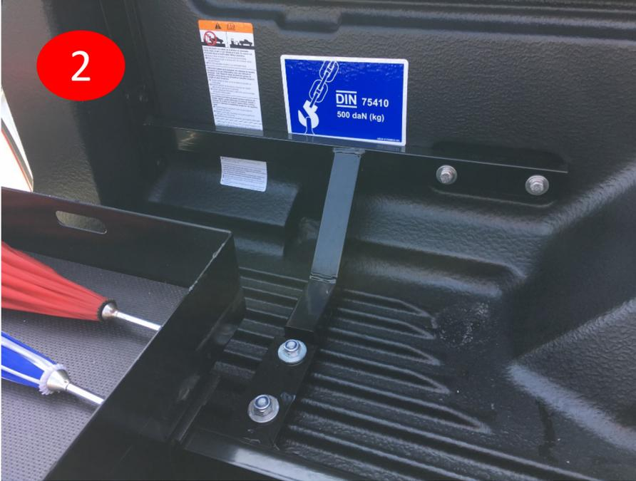
3. Montieren Sie, wie auf Abbildung 2 zu erkennen ist, die Halterungen links und rechts.
