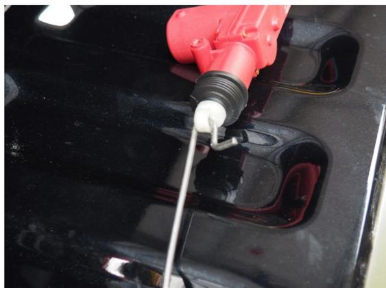
7) Verbinden Sie das andere Ende der Stange mit dem Schließmechanismus.
