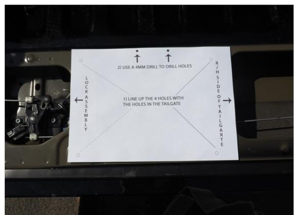
5) Bohrungen für die Befestigung des Stellmotors. Bitte benutzen Sie einen 4mm Bohrer für Metall.
