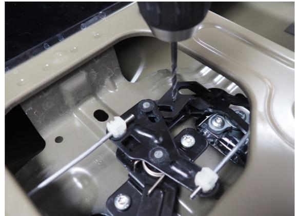
3) 4mm Bohrung in Schließmechanismus
