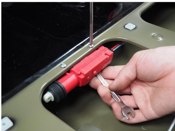
9) Führen Sie den Kabelbaum in die Heckklappe und verbinden ihn mit dem Stellmotor ROT an ROT und SCHWARZ an BLAU.
