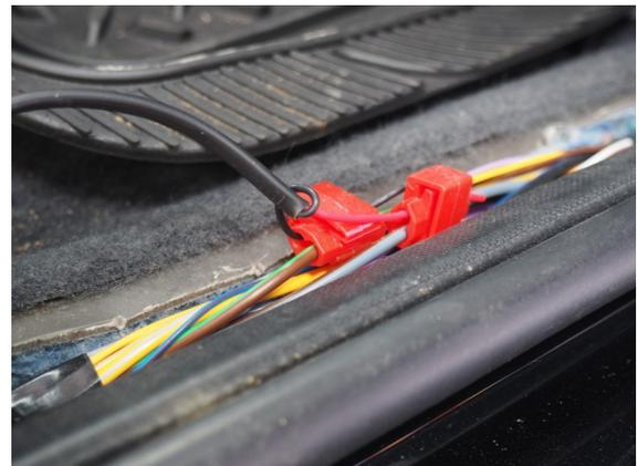
**\*Wir empfehlen alle Kabelverbindungen mit Isolierband zu schützen. Versichern Sie sich ebenfalls, das der ZV-Kabelbaum nicht an Hitzequellen wie zum Beispiel Auspuffrohren etc. anliegt.**
